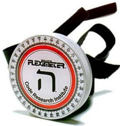
F lexômetro para aferição de medidas angulares.
