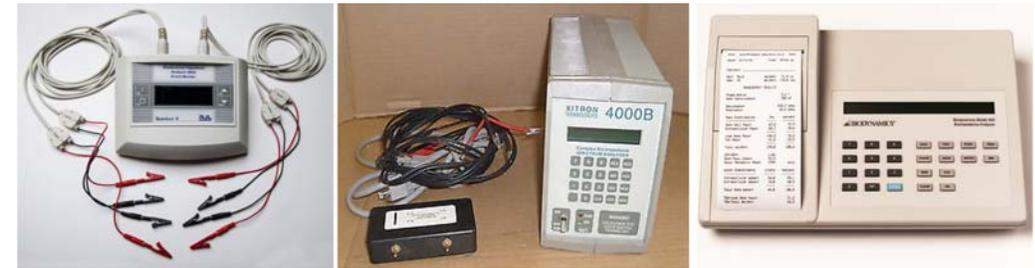
Figura 4.3 – Equipamentos para análise da composição corporal pela técnica tetrapolar de bioimpedância elétrica.
