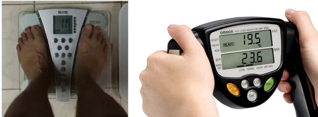
Figura 4.5 – Análise da composição corporal pela técnica bipolar de bioimpedância elétrica.
